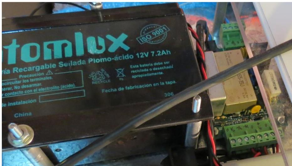
**Figura 8.-** UPS-CC y batería convencional de 12V / 7Ah con carga vía 220V y Panel FV
