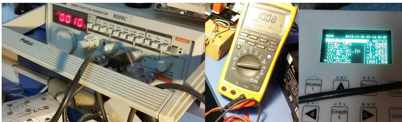
**Figura 24.-** Verificación de entrada senoidal Freq\_NRG (10Hz) en CR1000X, producida con Protek 9205, y verificación con Fluke F189.
