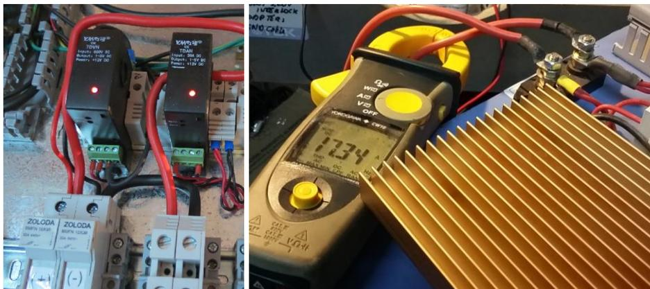
**Figura 14.-** Calibración de la parte de corriente continua, Sensor TDAH para  $I_{DC}$ .
