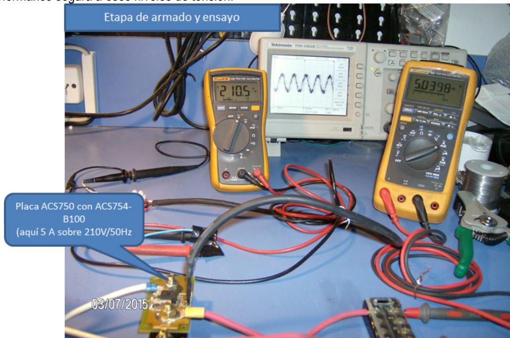
Figura 4.8 – Corriente alterna - Ensayo de Placa ACS750 con ACS754 B-100 sobre 230 Vac (2015)
